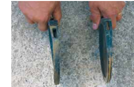
Überdrehter Schieber: ersetzen!
